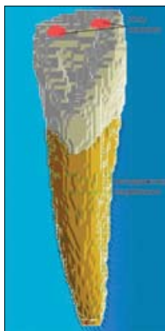
■Рис. 9. Условия нагружения и закрепления. Внешняя поверхность корня неподвижно закреплена в окружающих тканях
