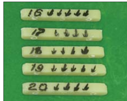
■ Рис. 8. I серия — (контрольные) образцы, изготовленные из микрогибридного композитного материала Filtek™ Z-250
