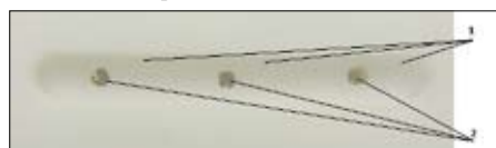
■ Рис. 3. Полипропиленовая форма для изготовления композитных и сеточно-металлокомпозитных образцов: 1) сформированная полость прямоугольной формы; 2) сквозные отверстия для выдавливания готовых образцов из формы
