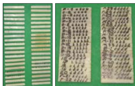
■ Рис. 4. а) Образцы, изготовленные из композитного материала Filtek™ Z-250 и сеточного металлокомпозита “композитный материал Filtek™ Z-250 — металлическая позолоченная переплетенная сетка”; б) На образцах маркером указаны порядковые номера и стрелками обозначены направления приложения нагрузки
